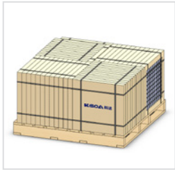
500×500(出口托、进仓托): 500 tile enclosed 木托尺寸: Support size: 1100×1100mm 数量: 48包 Qty: 48packs (12+12+12+12)
